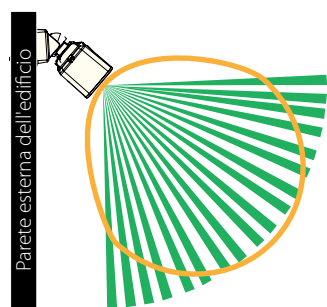
Copertura volumetrica a 90° con la staffa XD-WALLBRACKET
