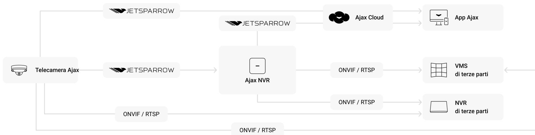
Le telecamere DomeCam Mini HL possono funzionare senza Ajax NVR: l'archivio video viene memorizzato localmente su una scheda microSD, se installata.
